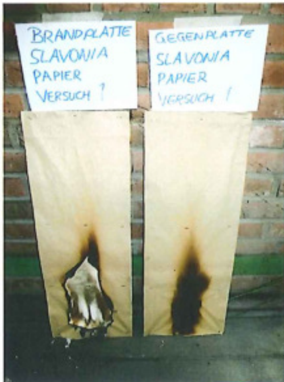
Bild 2 (Nr. 1030196): Probekörper nach Versuch 1
